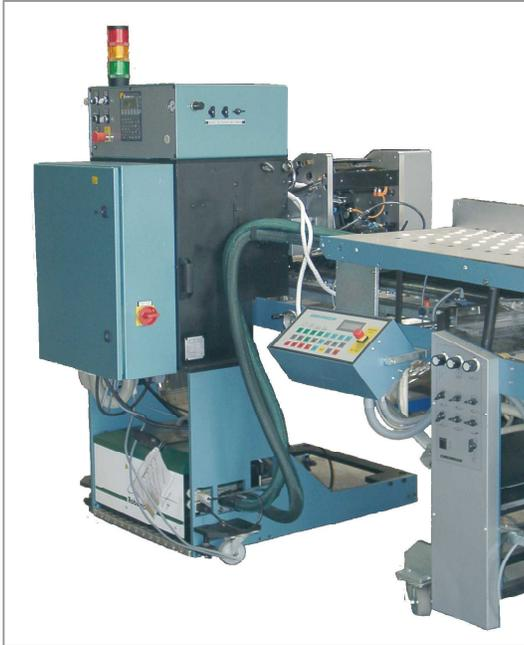
Der Kartenkleber Typ KI221 TB ist eine autarke Aufklebestation die in Kombination mit einem Zuführsystem als Inline-Aufklebestation eingesetzt werden kann.
