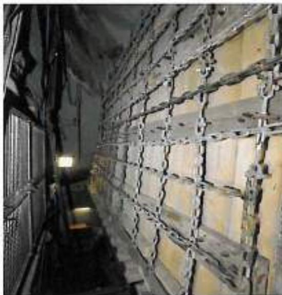
**Bild 22. Mobile Sprengwand geöffnet und geschlossen.**
